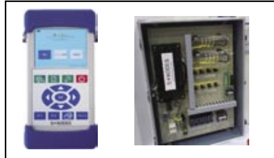
【左】ポータブル型のS☀️KODES 【右】接続箱組込型のS☀️KODES（試作機）
