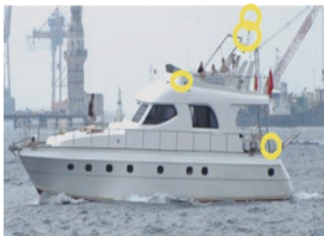
海上衝突予防法により、設置が定められている船灯 （マスト灯、左右舷灯、船尾灯など）
